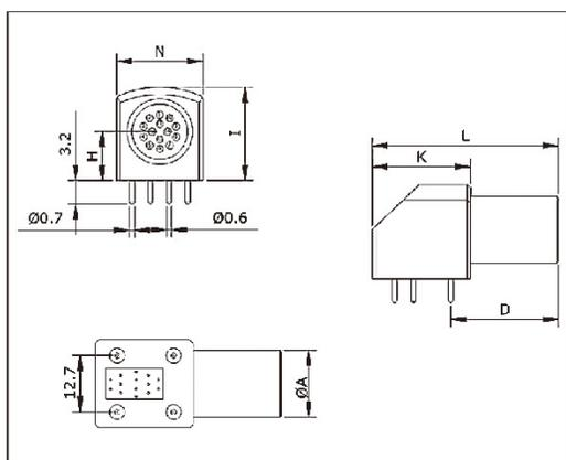
F-EPG 适用于印制线路板的90°弯角式插座，定位销(G)或定位销(A...F)(焊接或螺丝固定)
